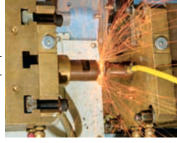
Centragem exata de chapa e porca abaulada
