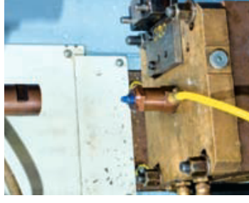
Pino de centragem de cerâmica CERAZUR em eletrodo completo
